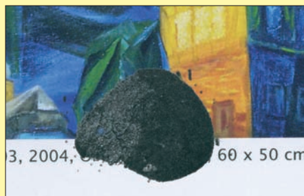
Störende Leimablagerung auf einer Seite eines Buches bei etwa 200 – 300 Exemplaren.
