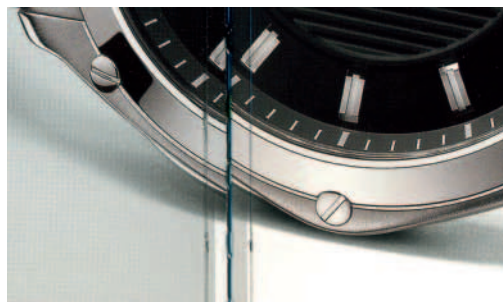
Beanstandeter Bildüberlauf der Falzbogen mit 2 mm Beschnitt im Bund.
