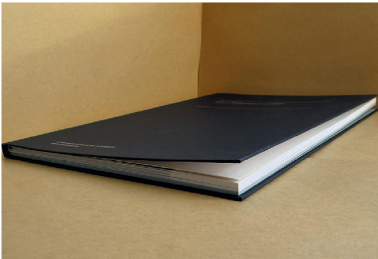
Nach dem Auspacken wiesen die Buchdecken ein deutlich erkennbares Aufwölben (Schnabeln) zur offenen Außenseite hin auf.
