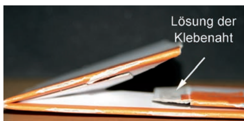
Faltschachtel aus der Ansicht des Faltbodens mit aufbrechenden Rillungen und abgelösten Längsnahtklebungen.
